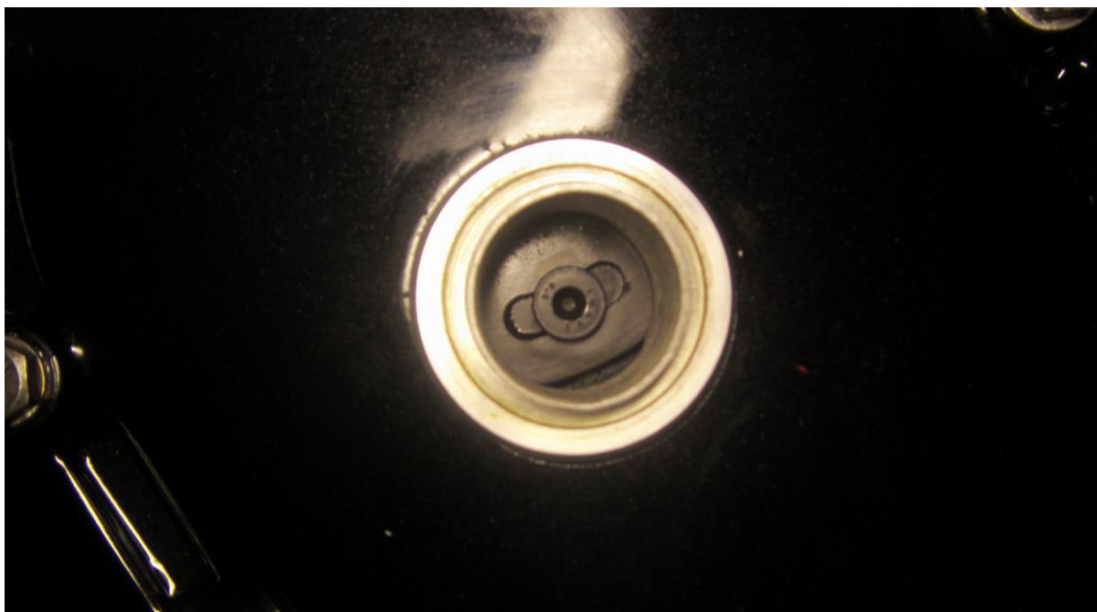
Vue de la poulie de distribution au travers du carter de distribution
