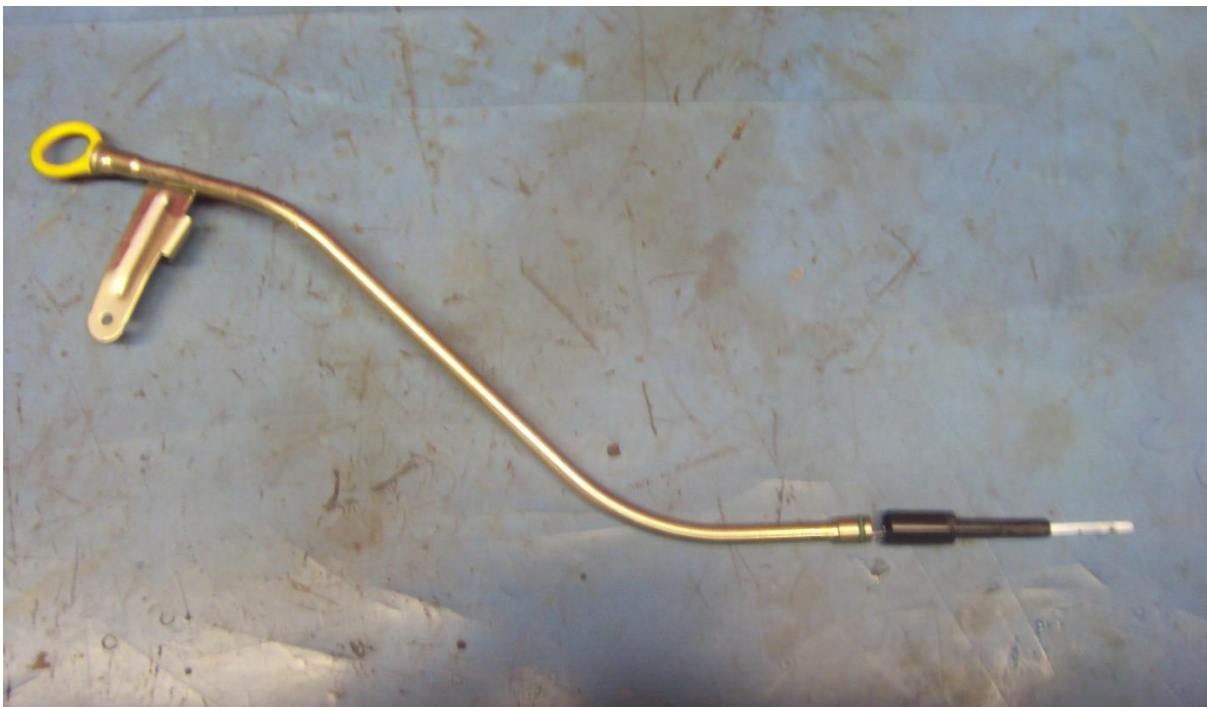
Jauge de Clio 3 avec pénétration dans le bloc de diamètre 10 mm
