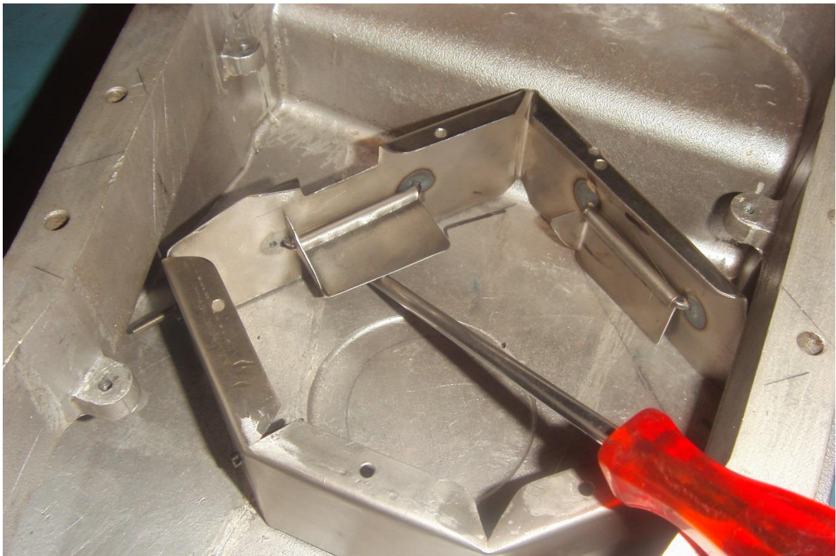
Cloisonnement du carter d'huile en cours de fabrication
