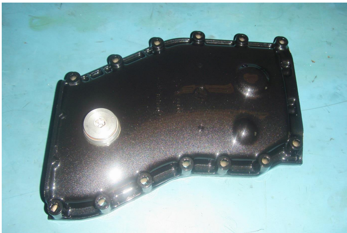
Fermeture de l'ouverture dans le carter de distribution
