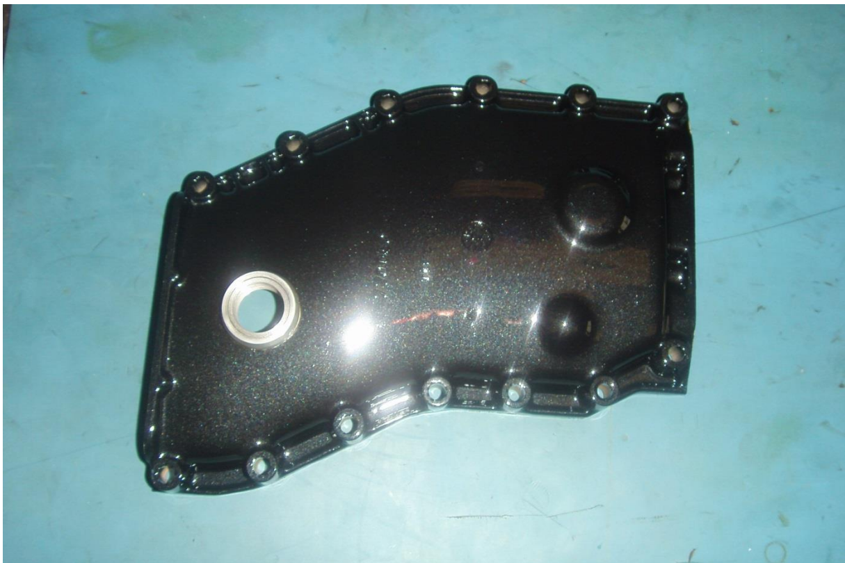
Ouverture dans le carter de distribution pour pouvoir accéder aux vis de la poulie réglable
